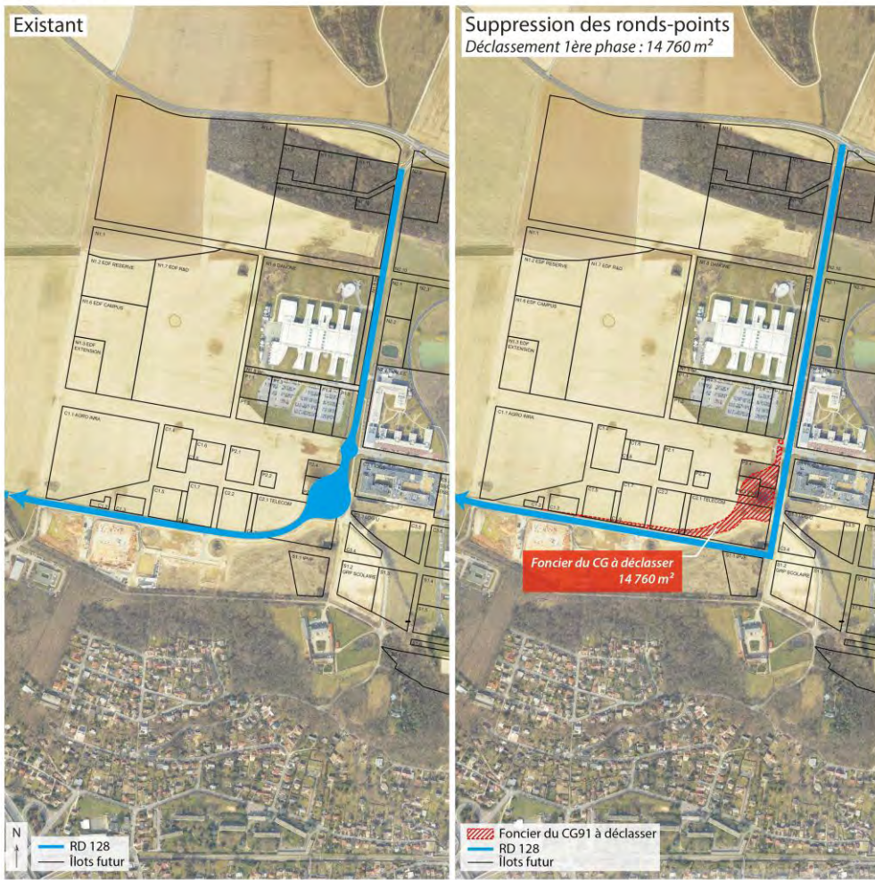
Figure 8. Procés sus de déplacement de la RD 128, axe de transit à l'ouest de la ZAC, EPPS, juillet 2013
