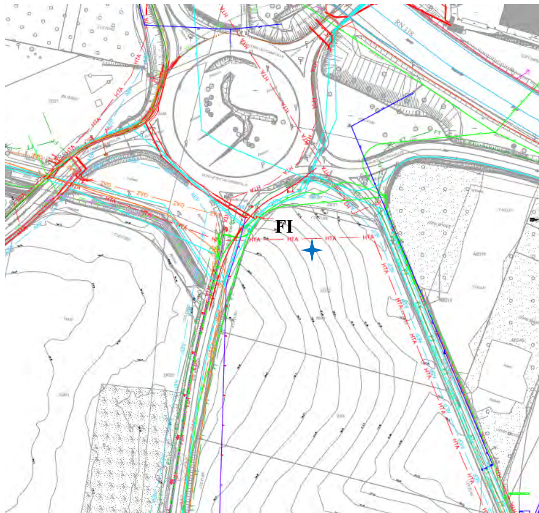
Figure 106. Réseaux existants à proximité du forage de production
