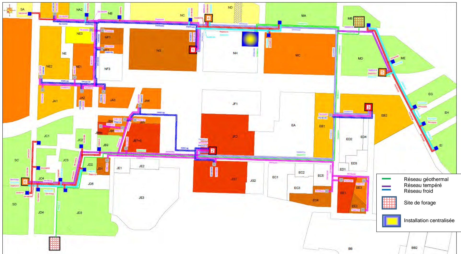
Figure 24. Plan du réseau de chaleur de la ZAC du Moulon
