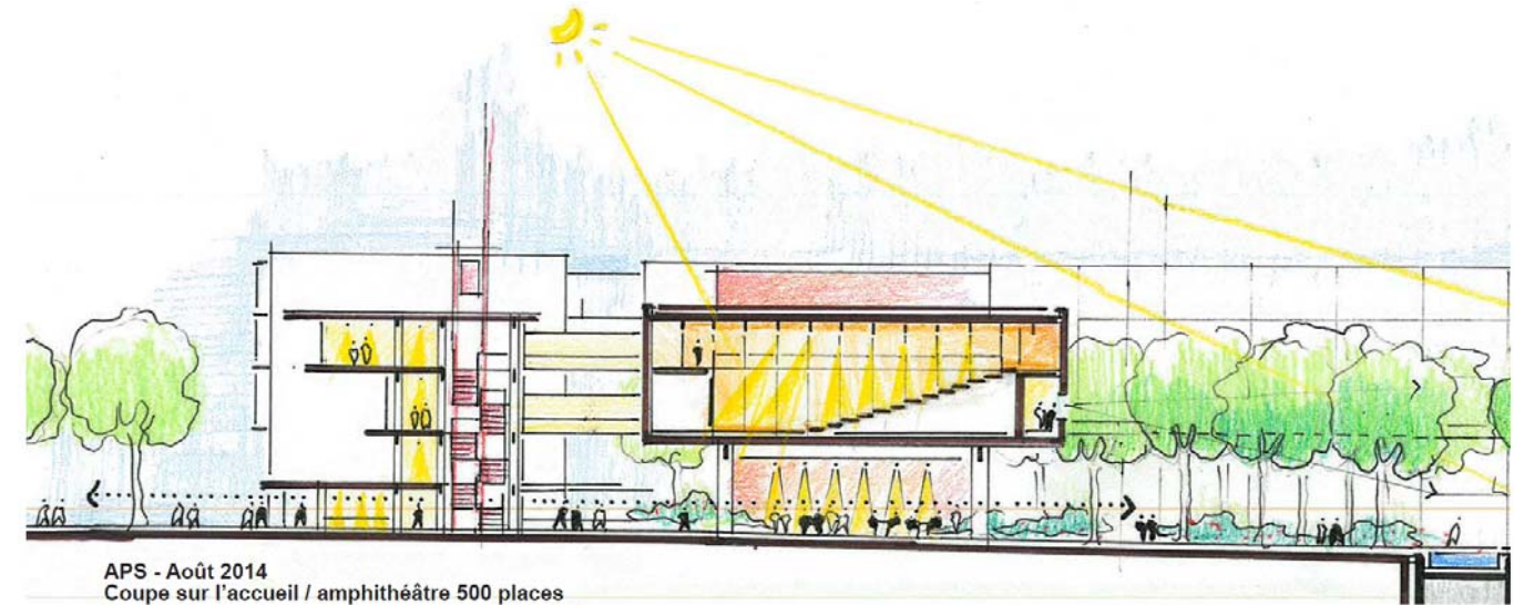
Figure 9 : Coupe transversale sur l'accueil, l'amphithéâtre et la « Fabrica »
