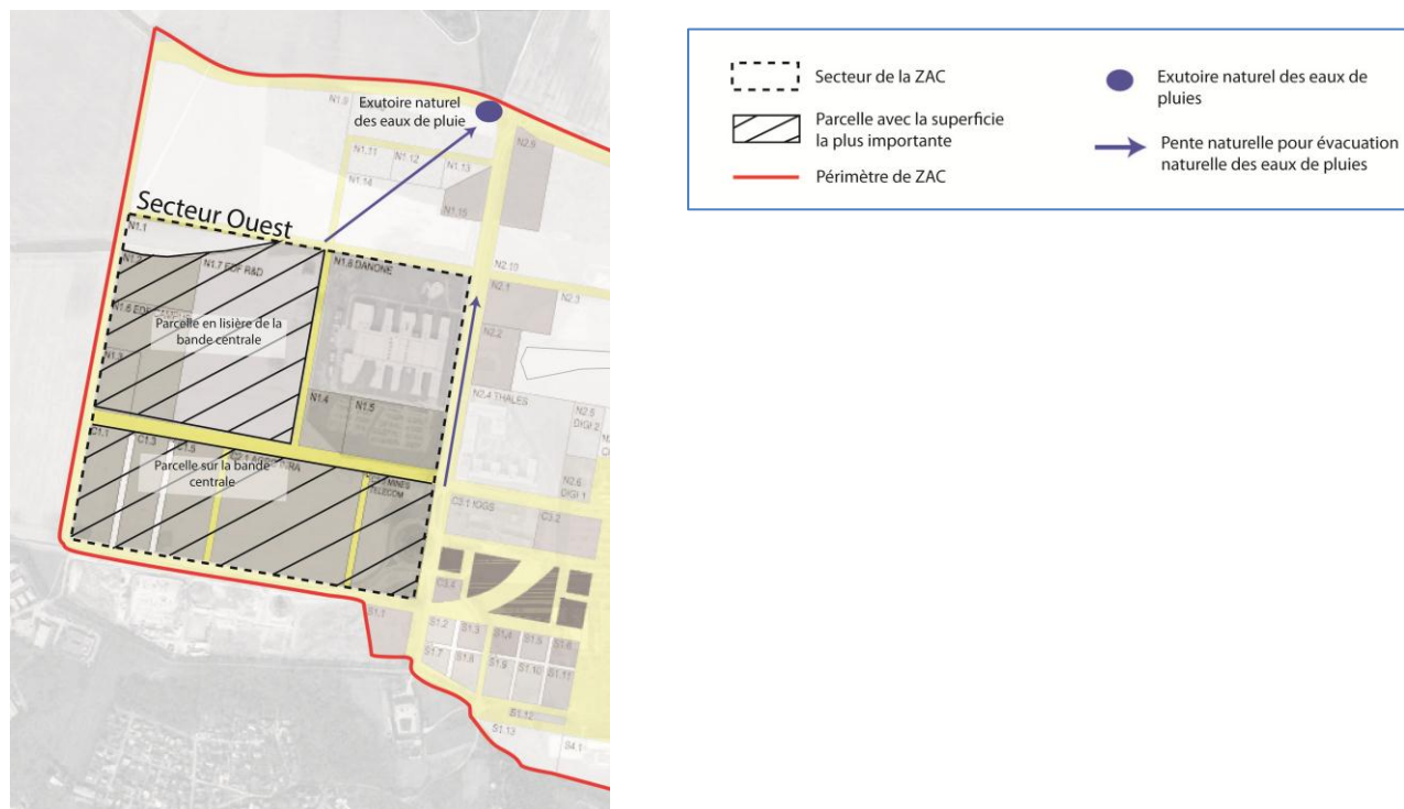
Figure 60. Exutoire des eaux de pluies et l'existant
