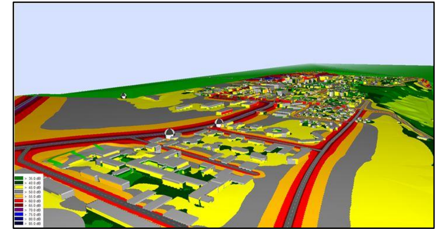
Figure 90 : Niveaux sonores en façade des bâtiments – Vue de la ZAC du nord-est
