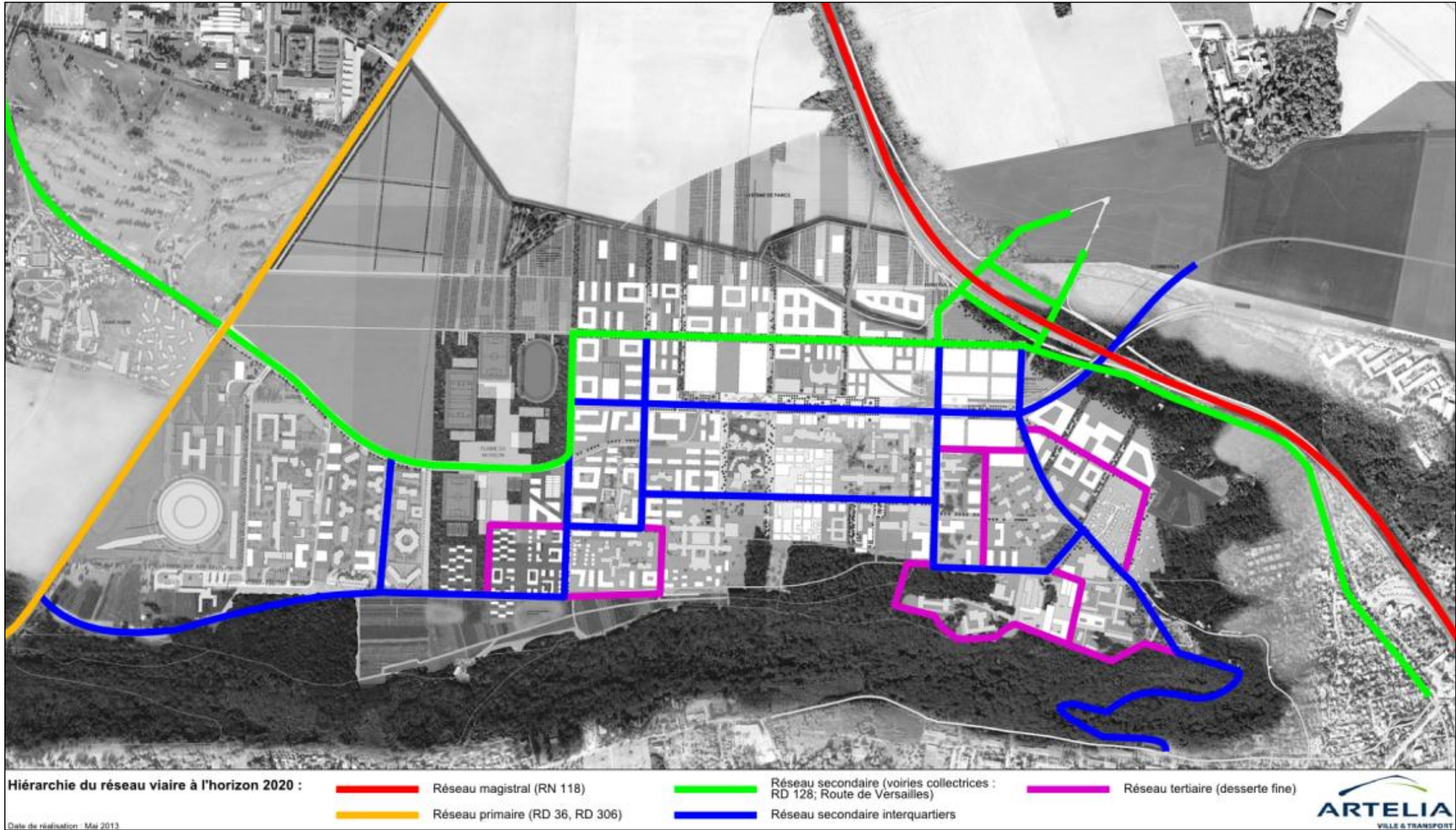
Figure 49 : Hiérarchie du réseau viaire à l'état projet
