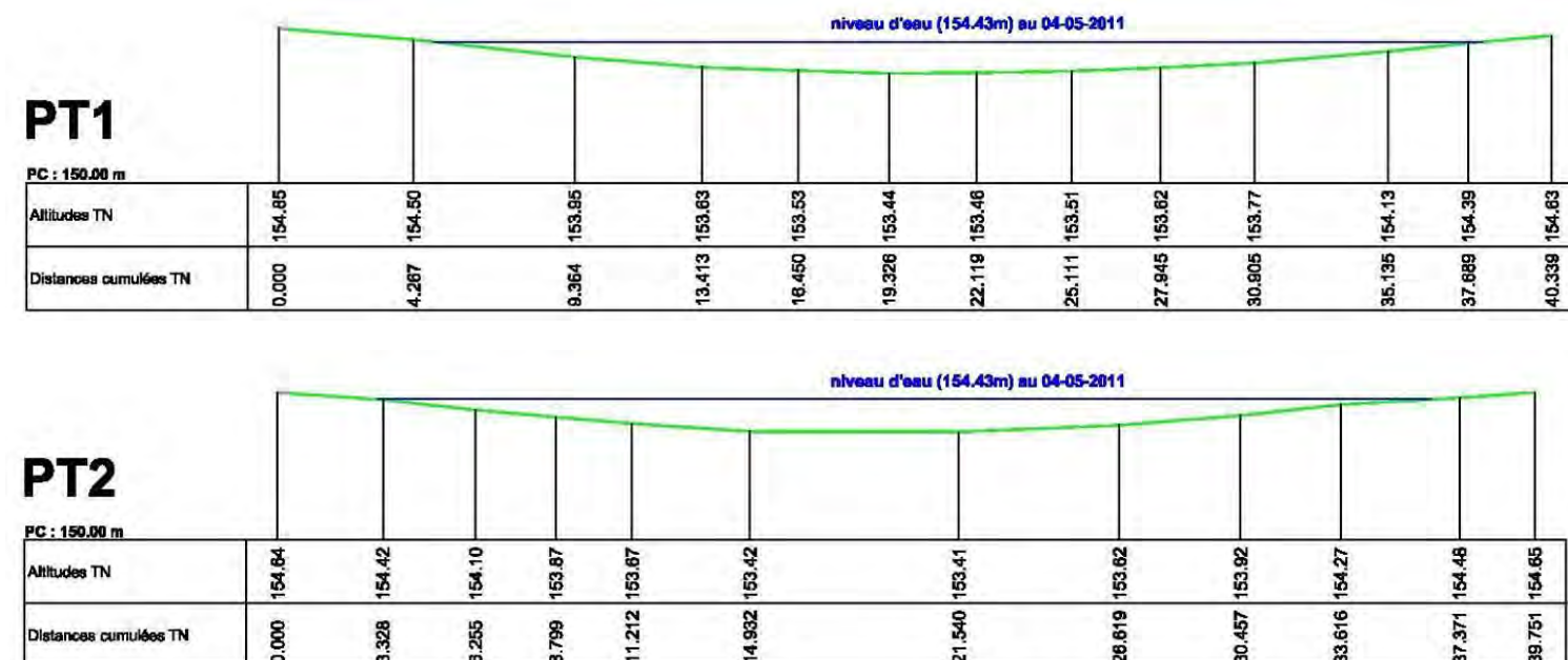
Figure 105. Profils de la mouillière et niveau d'eau mesuré le 04/05/2011 [ARTELIA, 2011]
