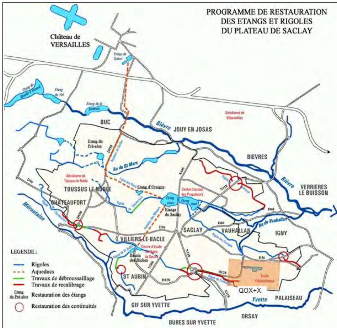
Figure 23. Programme de restauration des étangs et rigoles du plateau de Saclay et interfaces avec le quartier de l'École Polytechnique
