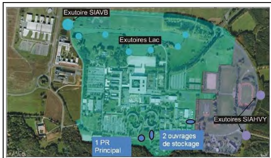
Figure 57. Délimitation des bassins versants des réseaux d'eaux pluviales du campus de l'École Polytechnique
