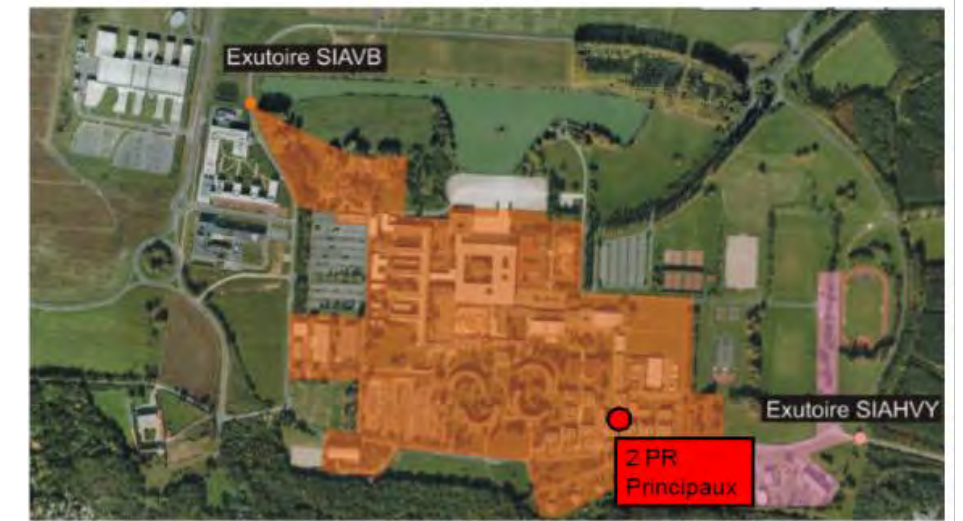
Figure 56. Délimitation des bassins de collecte des réseaux d'eaux usées du campus de l'École Polytechnique
