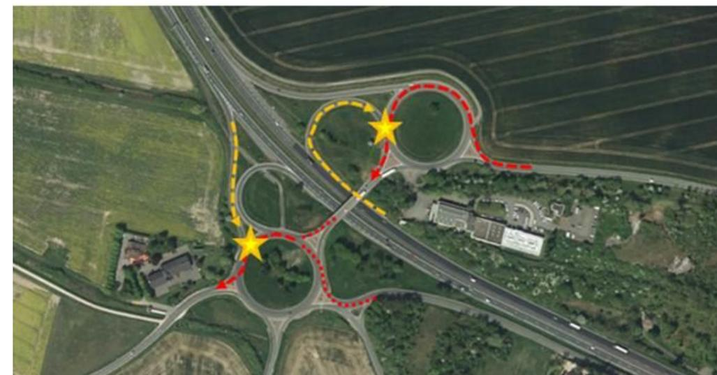
Ainsi les flux attendus à court terme ne peuvent être écoulés de manière fluide par l'échangeur dans sa configuration actuelle. Les flux à l'horizon long terme (2030) étant plus importants qu'à l'horizon court terme, l'échangeur saturera d'autant plus.
